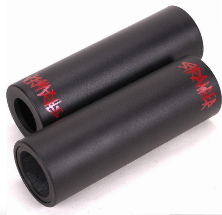
**Pegs** sind verlängerte Trickachsen, mit den man an Kanten von Rampen oder auch im Streetbereich rutschen kann
